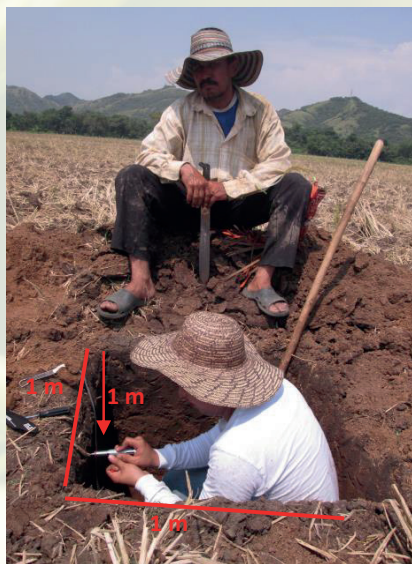
Figura 2. Caracterización del perfil de suelo, en una calicata.
