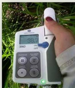
Figura 21. Clorofilómetro o SPAD.
