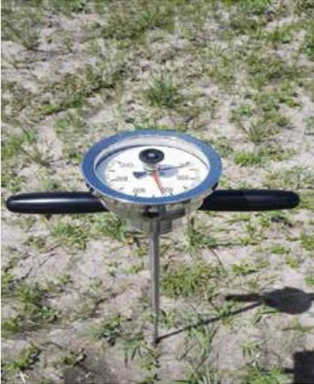
Figura 14. Penetrómetro de cono.
