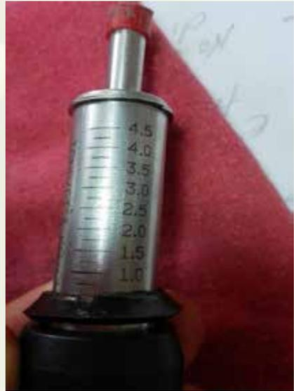
Figura 15. Penetrómetro de bolsillo.
