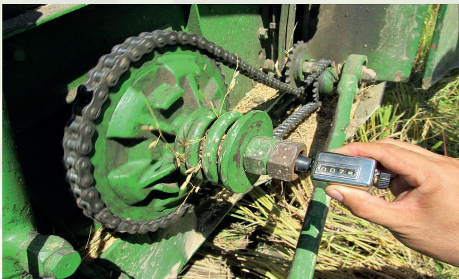
Figura 28. Adaptación de piñones que modifican la velocidad de los elementos
