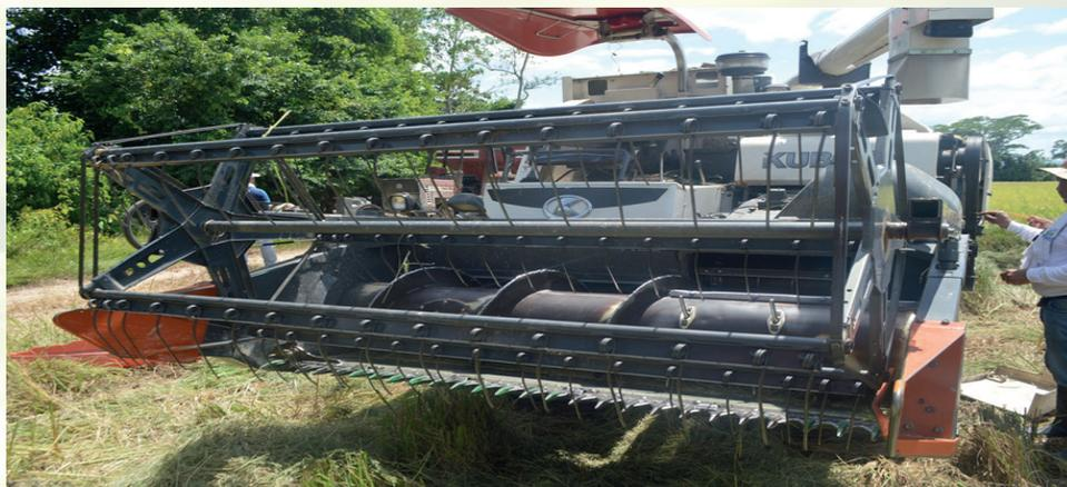
Figura 8. Molinete y sistema de corte en la cosechadora
