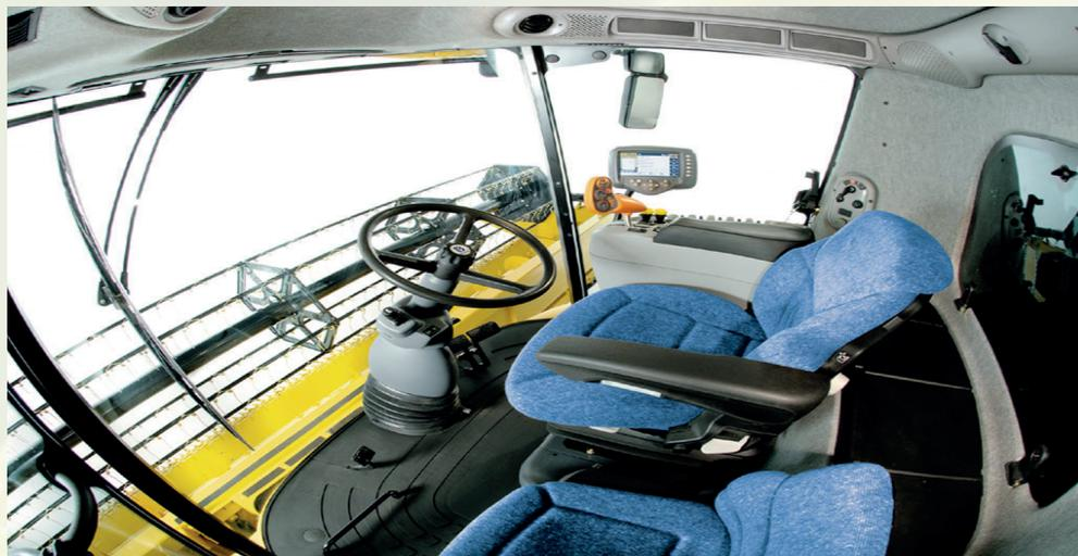
Figura 12 cosechadora con tableros y sensores de pérdidas para calibrarla desde la cabina de mando
