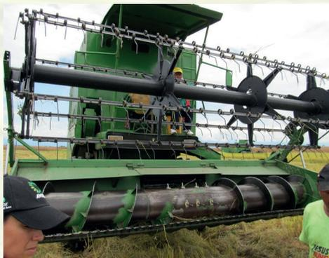
Figura 20 caracol con dedos retractiles en buenas condiciones
