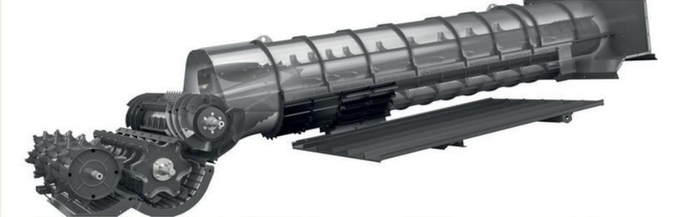
Figura 10. Sistema de trilla axial
