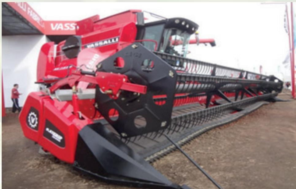
Figura 27. Cabezal Draper o alimentación por lonas
