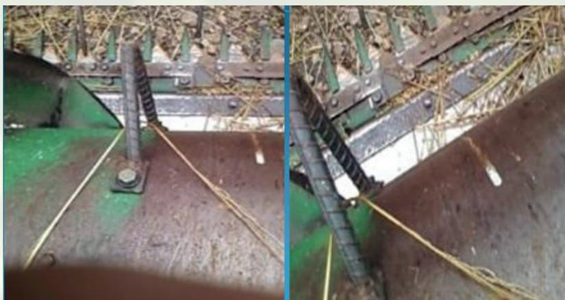
Figura 19. Reemplazo de los dedos retractiles por varillas
