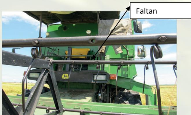
Figura 21. Molinete sin ganchos y en mal estado
