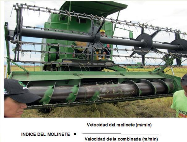
Figura 25. Cálculo del índice del molinete
