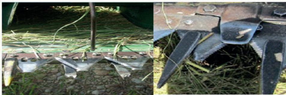
Figura 17 Cuchillas y guardas mal dirigidas y en mal estado
