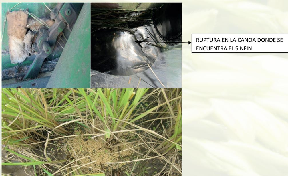
Figura 24. Pérdidas por rupturas en la combinada o fugas
