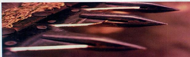
Foto 3: Cuchillas y guardas en mal estado, cuchilla partida.
