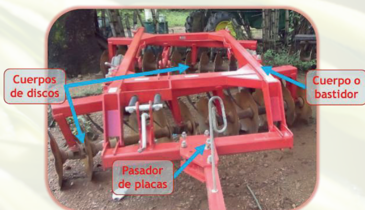
Figura 8. Partes de la rastra excéntrica (Fuente: Jorge Luque Leandro-Fedearroz)
