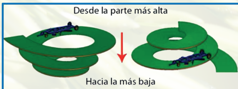
Figura 15. Diagrama de formas de trabajo en campo con la micro-niveladora (Captura de pantalla, video: micro-niveladora arroz, de Industrias. Soto 2015)
