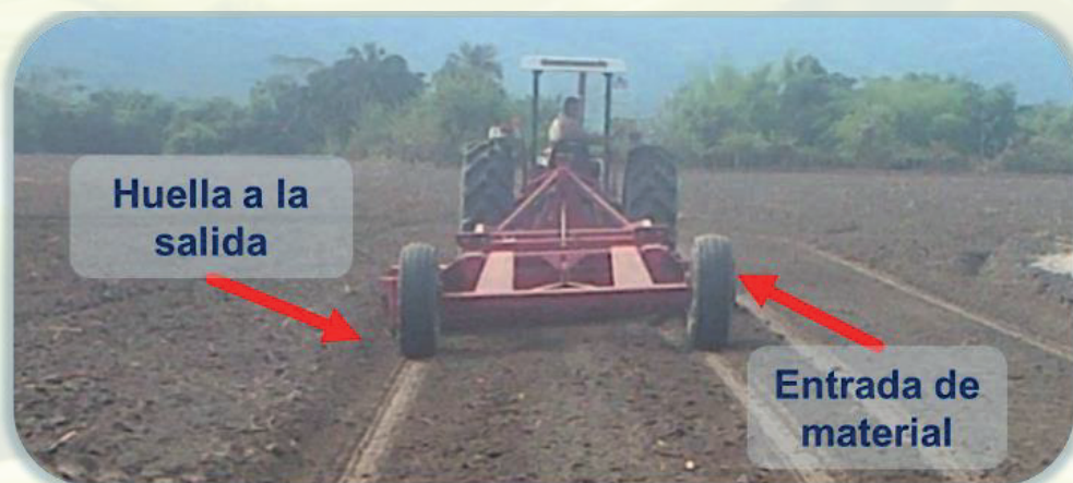
Figura 16. Forma de trabajo en campo de la microniveladora (Fuente: Jorge Luque Leandro-Fedearroz)
