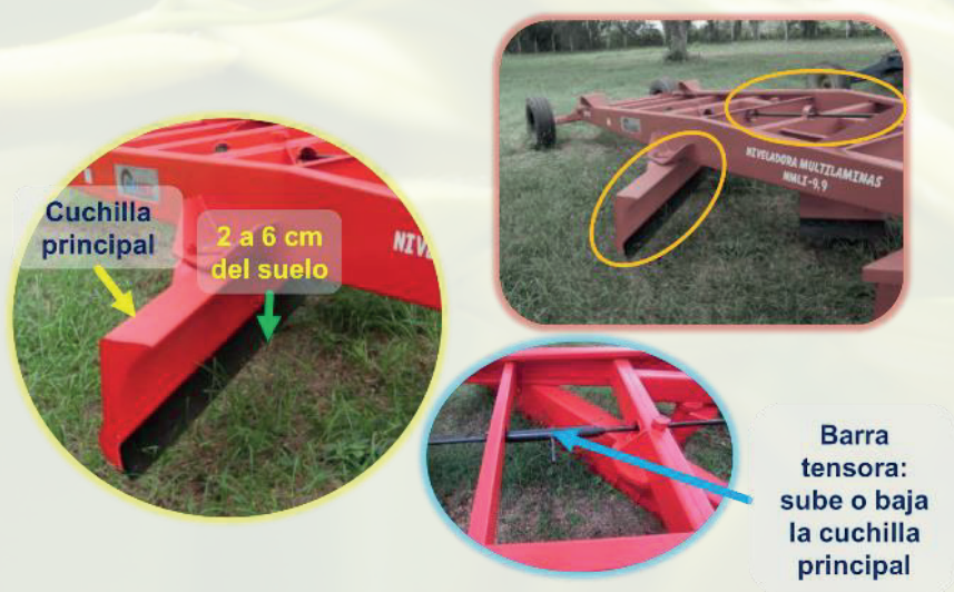
Figura 13. Puntos de calibración micro-niveladora II (Fuente: Jorge Luque Leandro-Fedearroz)
