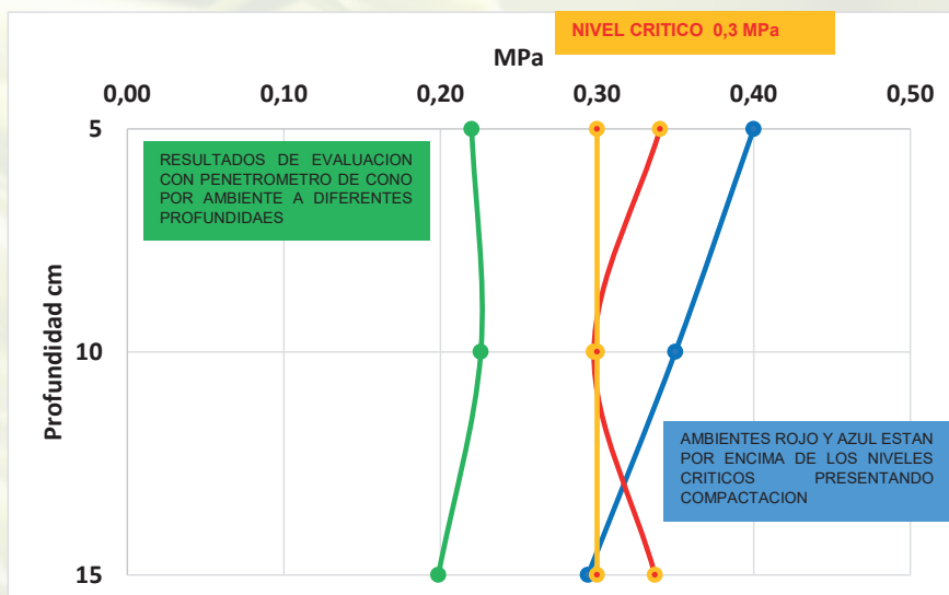
Figura 1. Ejemplo de análisis de compactación por ambiente toma de datos penetrómetro de cono donde la línea amarilla es el nivel crítico máximo permitido para un buen desarrollo de las raíces- Finca Piamonte. Ibagué. 2017
