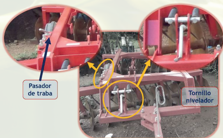
Figura 9B. Puntos de calibración rastra excéntrica (Fuente: Jorge Luque Leandro-Fedearroz)
