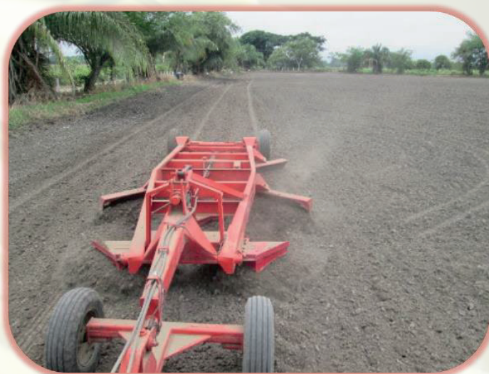
Figura 11. Micro-niveladora trabajando (Fuente: Jorge Luque Leandro-Fedearroz)
