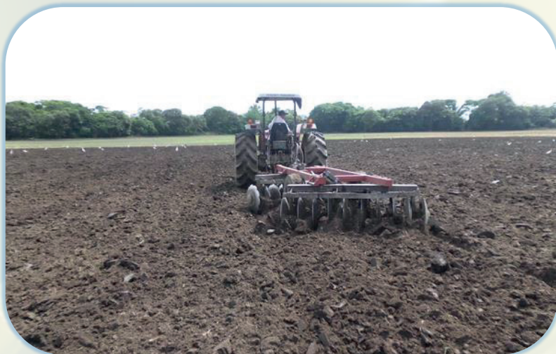
Figura 7. Equipo de rastra excéntrica trabajando en campo (Fuente: I.A. John Jairo Ospina-Fedearroz Fondo Nacional del Arroz).
