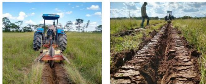
*Figura 4. Zanja realizada por le implemento luego de la modificación diseñada.*
