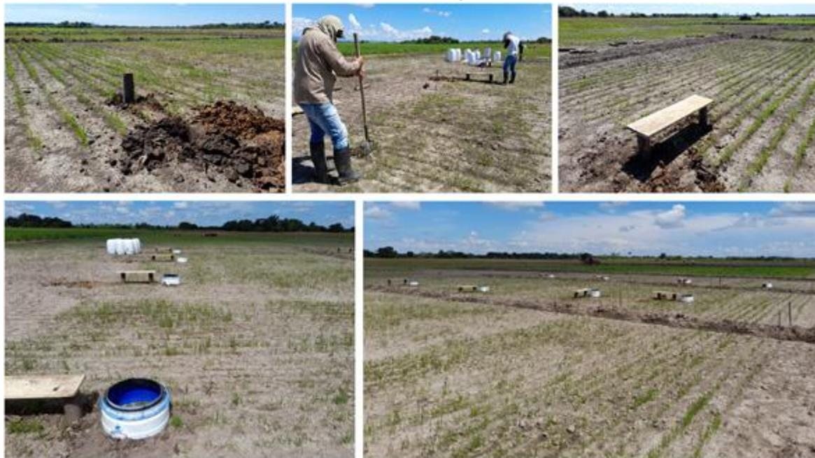
*Figura 32. Instalación de plataformas de madera y bases de las cámaras estáticas.*
